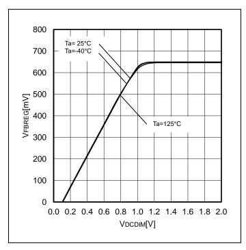
Figure 7.  $V_{\text{FBREG}}$  vs  $V_{\text{DCDIM}}$
