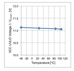
Figure 19. VCC UVLO Voltage 1 vs Temperature (BM2P131X-Z, BM2P141X-Z, BM2P151X-Z, BM2P161X-Z, BM2P281X-Z, BM2P201X-Z, BM2P241X-Z)
