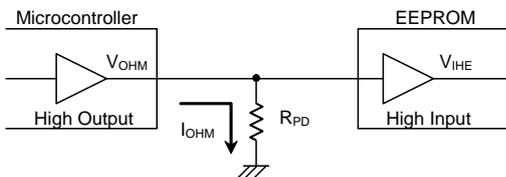
$$R_{PD} \geq \frac{V_{OHM}}{I_{OHM}} \quad (3)$$
