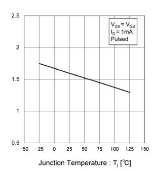
Gate Threshold Voltage :  $V_{GS(th)}\left[V\right]$
