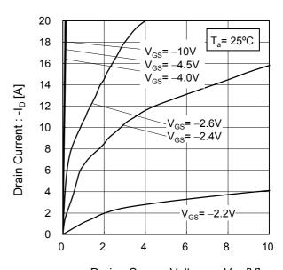
Drain - Source Voltage : -V<sub>DS</sub> [V]
