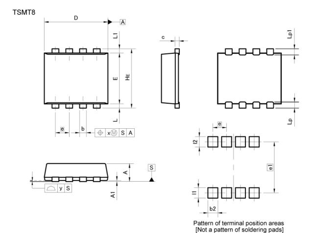
MILIMETERS INCHES DIM MIN MIN MAX MAX A 0.75 0.85 0.030 0.033 A1 0.00 0.05 0.000 0.002 b 0.27 0.37 0.011 0.015 C 0.12 0.22 0.005 0.009 D 2.90 3.10 0.114 0.122 2.30 0.091 0.098 2.50 Е 0.65 0.026 е 2.70 2.90 0.106 0.114 HE 0.10 0.30 0.004 0.012 L L1 0.10 0.30 0.004 0.012 Lp 0.19 0.39 0.007 0.015 0.19 0.39 0.007 0.015 Lp1 0.10 0.004 0.10 0.004
