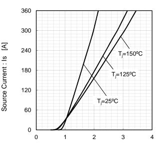
Source-Drain Voltage :  $V_{SD}$  [V]
