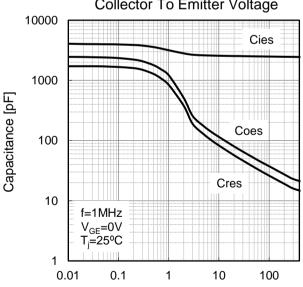
Collector To Emitter Voltage :  $V_{CE}[V]$
