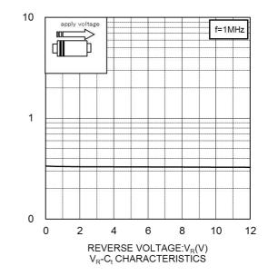
CAPACITANCE BETWEEN TERMINALS:C<sub>i</sub>(pF)
