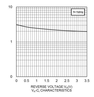
CAPACITANCE BETWEEN TERMINALS:C<sub>i</sub>(pF)
