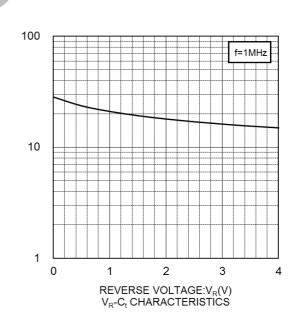
CAPACITANCE BETWEEN TERMINALS:C<sub>(</sub>(pF)
