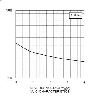
CAPACITANCE BETWEEN TERMINALS:C<sub>f</sub>(pF)
