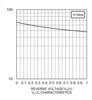
CAPACITANCE BETWEEN TERMINALS:C<sub>(</sub>(pF)
