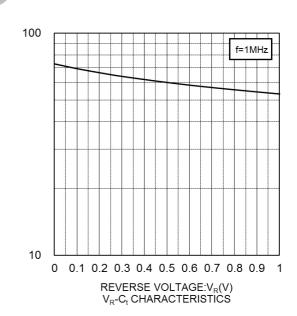
CAPACITANCE BETWEEN TERMINALS:C<sub>(</sub>(pF)
