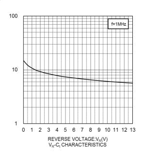
CAPACITANCE BETWEEN TERMINALS:C<sub>t</sub>(pF)
