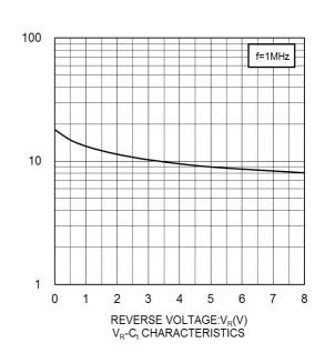
CAPACITANCE BETWEEN TERMINALS:C<sub>t</sub>(pF)
