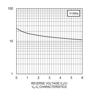
CAPACITANCE BETWEEN TERMINALS:C<sub>t</sub>(pF)
