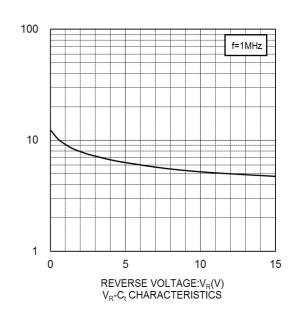
CAPACITANCE BETWEEN TERMINALS:C<sub>t</sub>(pF)
