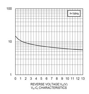
CAPACITANCE BETWEEN TERMINALS:C<sub>t</sub>(pF)
