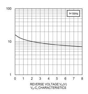
CAPACITANCE BETWEEN TERMINALS:C<sub>t</sub>(pF)
