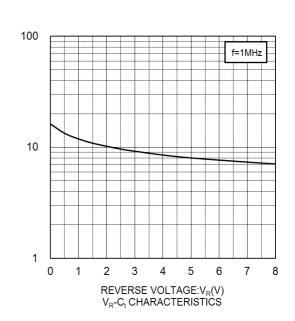
CAPACITANCE BETWEEN TERMINALS:C<sub>t</sub>(pF)
