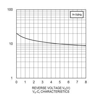
CAPACITANCE BETWEEN TERMINALS:C<sub>t</sub>(pF)
