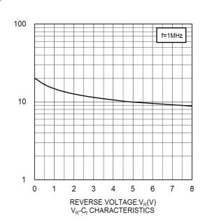
CAPACITANCE BETWEEN TERMINALS:C<sub>t</sub>(pF)
