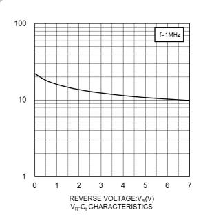
CAPACITANCE BETWEEN TERMINALS:C<sub>t</sub>(pF)
