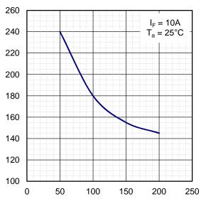
RATE OF CHANGE OF CURRENT : di/dt(A/ $\mu$ s) di/dt-V<sub>Fp</sub> CHARACTERISTICS
