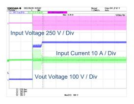
Figure 20.Start Up V<sub>IN</sub> = 264 V<sub>ac</sub>
