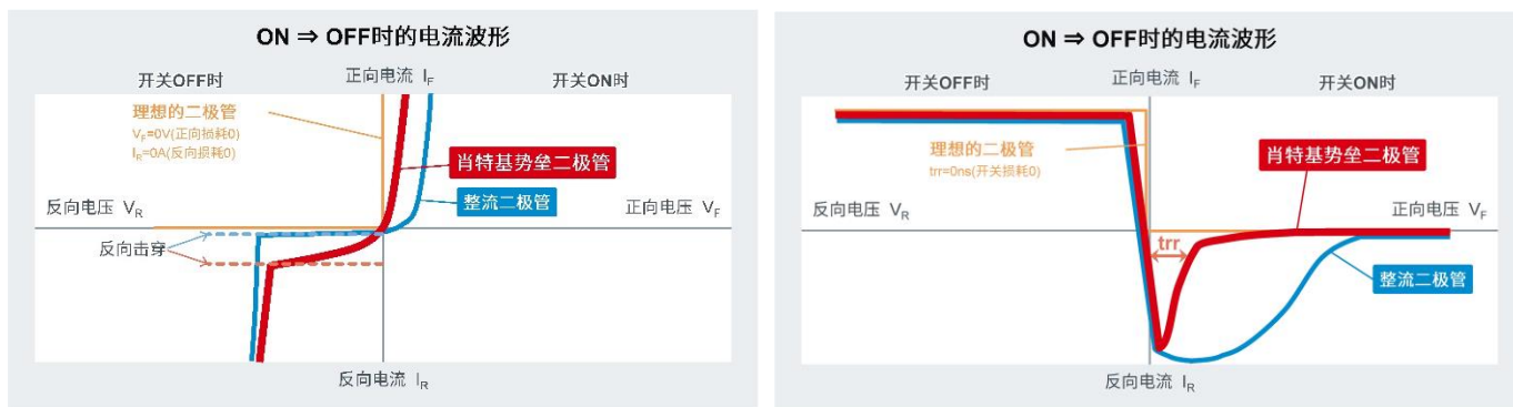
图 2. 在开关期间 SBD 和整流二极管的 V_F 、 I_R 比较
