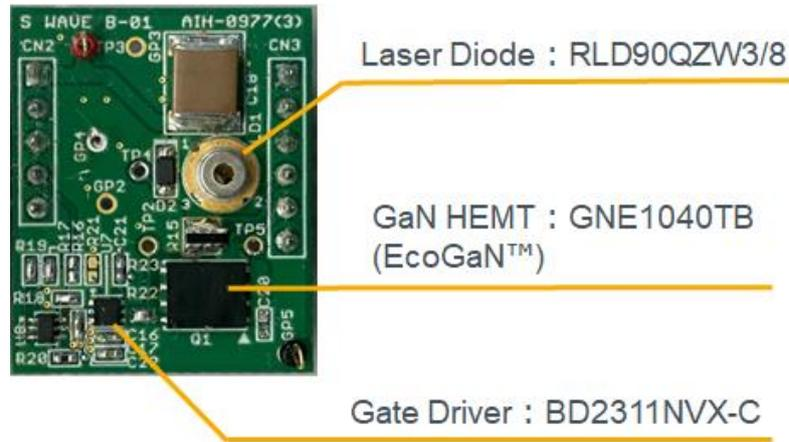
图 4：面向 LiDAR 参考设计 [REFLD002]
