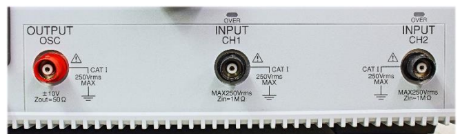
Figure 5 各端子与壳体之间的电气绝缘耐压
