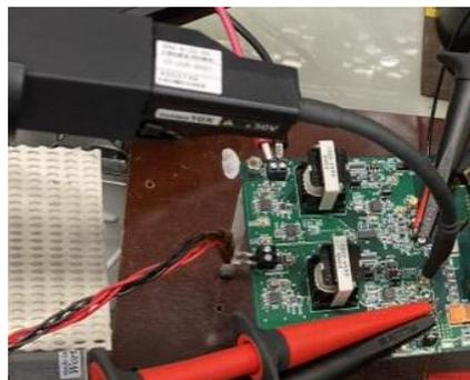
(b)使用光隔离探头进行测量
