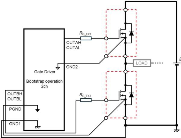
图 7. 使用 ROHM BM60213FV-C 时的电路图
