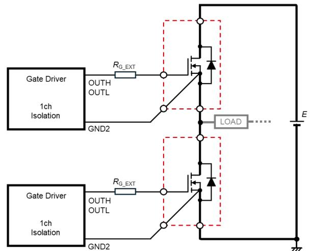
图 6. 使用 ROHM BM61x4x 时的电路图
