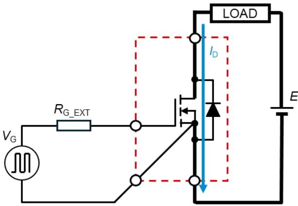
图 3. 带有驱动源极端子的 MOSFET 连接电路
