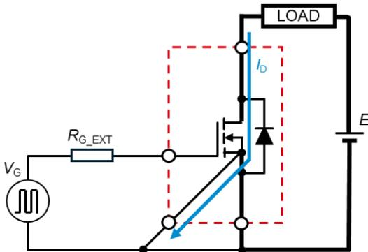
图 4. 直接连接驱动源极端子和功率源极端子
