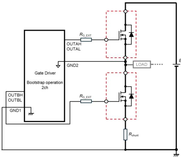
图 12. 将  $R_{shunt}$  连接到栅极驱动电路内侧
