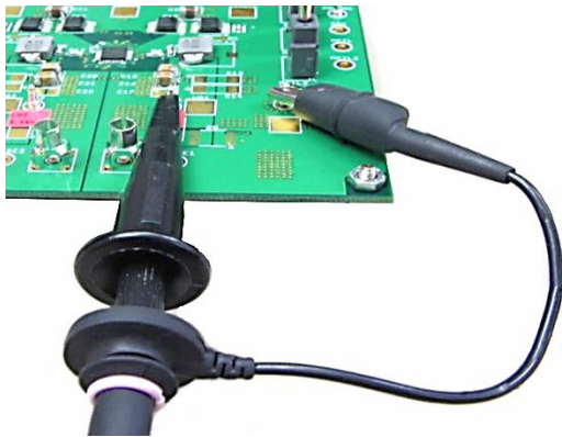
Figure 1. 电压探头监测开关位置，GND 侧与附属的鳄鱼夹的接地引线相连接
