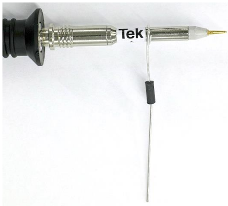
Figure 8. 制作适配器的接地支持部分
