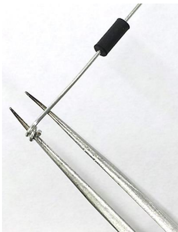
Figure 9. 制作适配器的尖端支持部分
