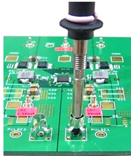
Figure 6. 使用探头尖端适配器来监测开关位置的状态
